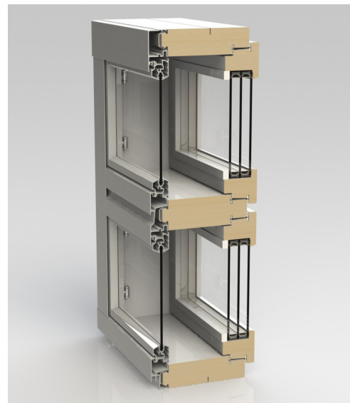
MSE3-A -ikkunan sisäpuitteessa on kolminkertainen eristyslasi. Ulkopuitteessa on tasolasi.
